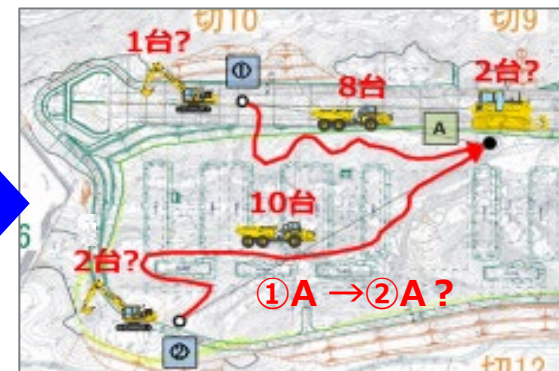
施工手順を検討
